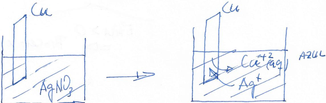
El color azul de la disolución indica la presencia del ion  $\text{Cu}^{+2}$  en la disolución. Por tanto, parte de  $\text{Cu}$  metálico se habrá oxidado, cediendo electrones, que pueden utilizar los iones  $\text{Ag}^+$  de la disolución para reducirse y depositarse sobre la placa de cobre como  $\text{Ag}$  sólida.
