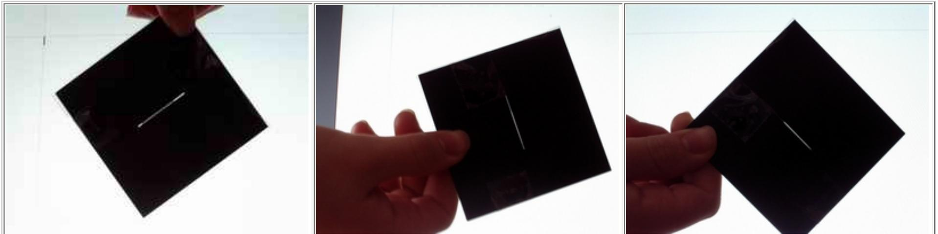
Foto 5. La lámina polarizadora está en la misma posición que en la foto 1. Vemos que el caramelo deja pasar poca luz. En los extremos de la rendija la luz pasa normalmente.
