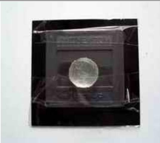
**Foto 3.** Montaje experimental. Cartulina con una rendija, lámina polarizadora y caramelo transparente.
