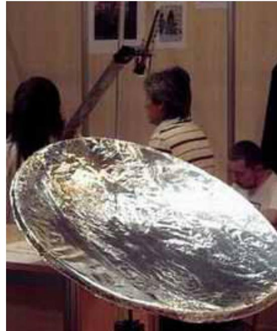
La superficie parabólica debe orientarse hacia el Sol, de forma que los rayos lleguen paralelos al eje de la parábola. Para ello basta con que la barra que sujeta el sensor apunte hacia el Sol. Una buena forma de orientar el dispositivo es conseguir que la barra no proyecte sombra sobre la parábola.
